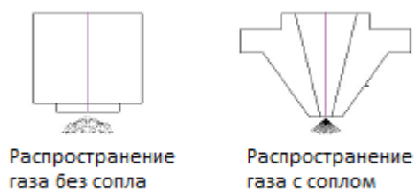
Влияние сопла на распространение газа
