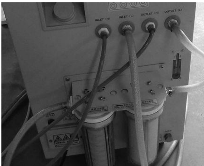
Фильтры для воды в чиллере
