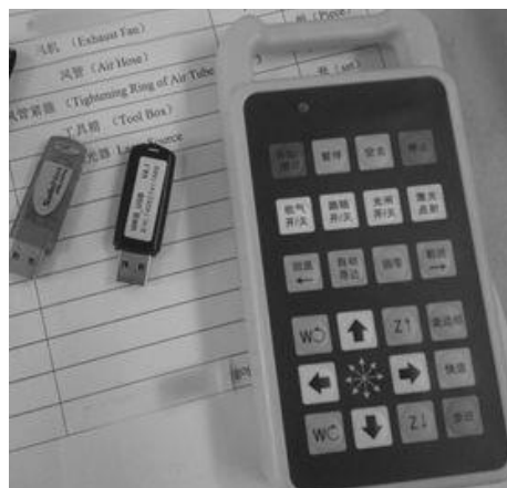
Выносной пульт оператора станка
